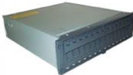
В зависимости от выбранной модели контроллера, система хранения данных NetApp может иметь до 102 таких дисковых полок (в модели FAS6280). Возможно одновременное подключение к одному контроллеру как дисковых полок с FC дисками, так и с SATA дисками.
